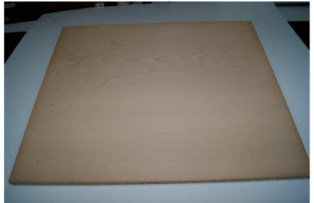
Poliuretano al disolvente bicomponente sobre tablero de partículas chapado con haya
