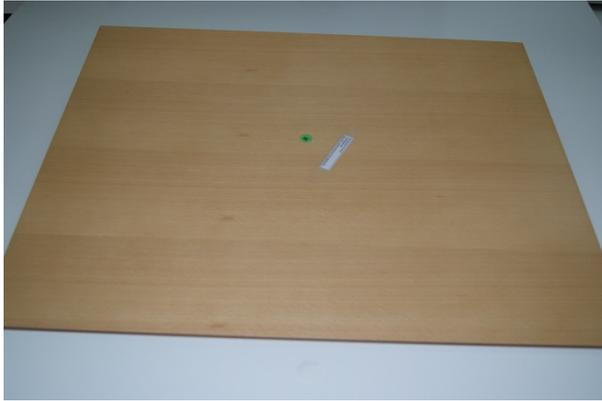
Poliuretano al agua monocomponente sobre tablero de fibras chapado con haya
